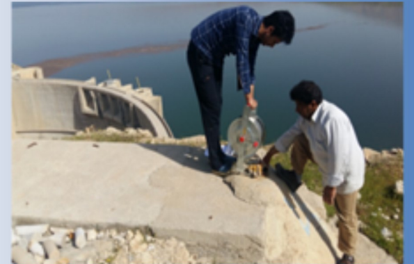
ترازسنجی و نمونه‌برداری از جاهای مشاهده‌ای
